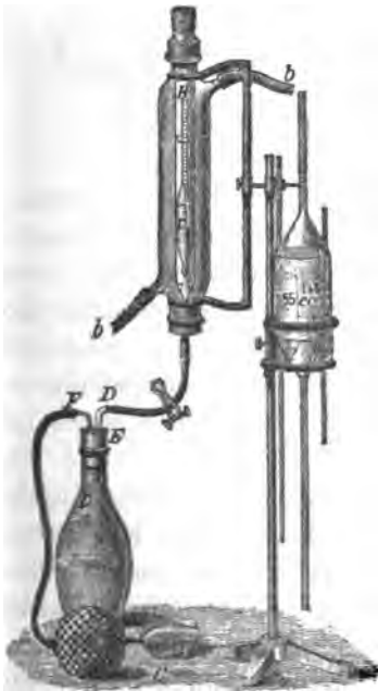
Aréometrischer Fettbestimmungsapparat von Prof. Soxhlet.
